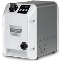
VACUU-PURE 10C Schraubenpumpe 9 m 3 /h, 5 x 10 -3 mbar Vakuumschluss: Kleinflansch DN 25
