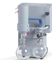
MD 4C NT +AK +EK Chemie-Membranpumpe 3.4 m 3 /h, 1.5 mbar Vakuumananschluss: Schlauchwelle DN 8-10
