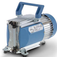
MD 1 Membranpumpe 1.2 m 3 /h, 1.5 mbar Vakuumanschluss: Schlauchwelle DN 6
