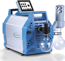
PC 3010 VARIO select Chemie-Membranpumpe 13.0 m 3 /h, 0.6 mbar Vakuumschluss: Kleinflansch DN 25
