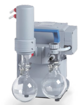
MZ 2C NT +AK +EK Chemie-Membranpumpe 2.0 m 3 /h, 7 mbar Vakuumananschluss: Schlauchwelle DN 8-10
